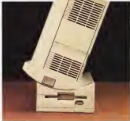
Compaq Portable 486C. In basso: il display di riserva. A destra: si illustra il meccanismo di inclinazione della CPU.
